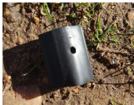
Dégâts de larves de taupins dans une gaine d'irrigation
