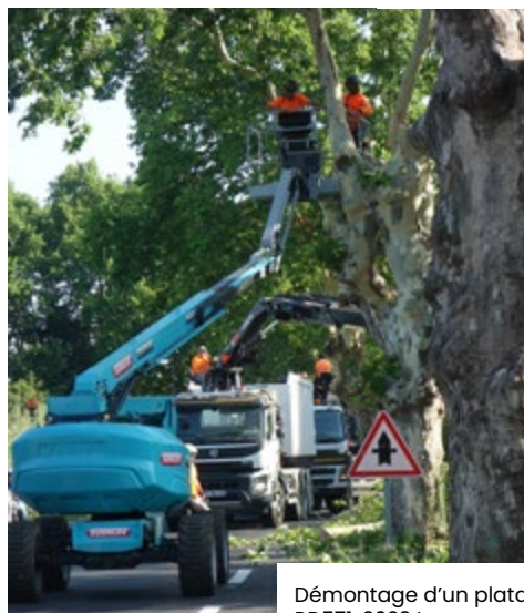
Rétention des tronçons et dépôt au sol découpés, Décines I © FREDON Auvergne-Rhône-Alpes
